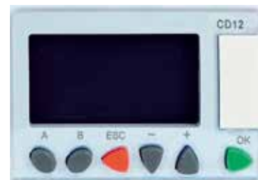
Mini PLC - Pic. 3
